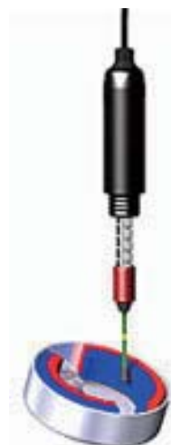
磁石内周面の測定
